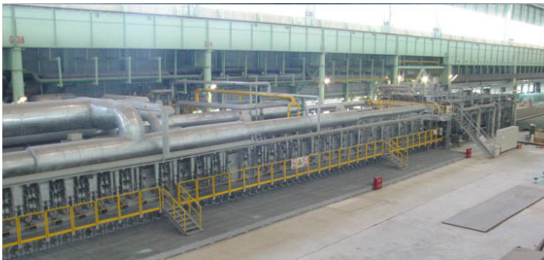
Fornace della "Tenova LOI italimpianti" per il trattamento termico dei metalli
